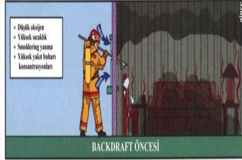
Şekil 12: Backdraft öncesinde yangının devamı için yetersiz oksijen ortamı söz konusudur.
